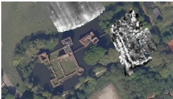
Afb. 28 Muurwerk in MAGdata (witte lijnen zijn puin-/ baksteenconcentraties).
