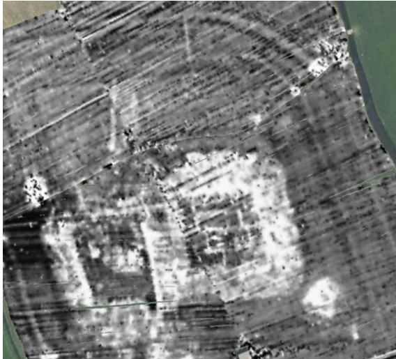
Afb. 21 Detail EMI (grachten, muurwerk en puin-concentraties zijn zichtbaar).
