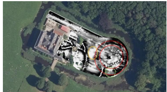
Afb. 15 EMI (ronde structuur zichtbaar, echter ook moderne kabels en leidingen).
