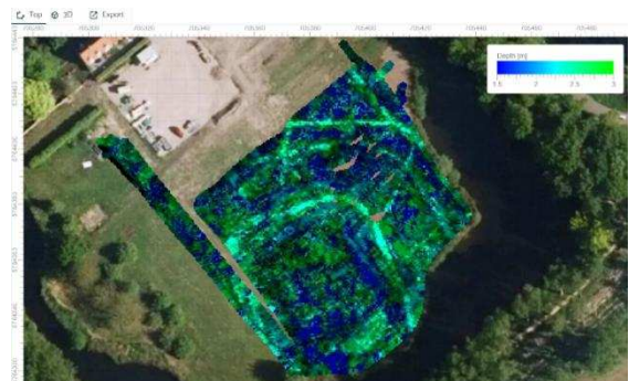
Afb. 31 GPR (Timeslice, lichte lijnen zijn gracht-structuren).
