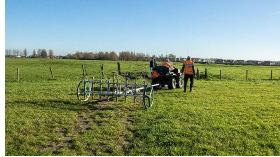
Afb. 5 MAG (8 magnetometriesondes, kasteel Oud-Haerlem, Heemskerk).
