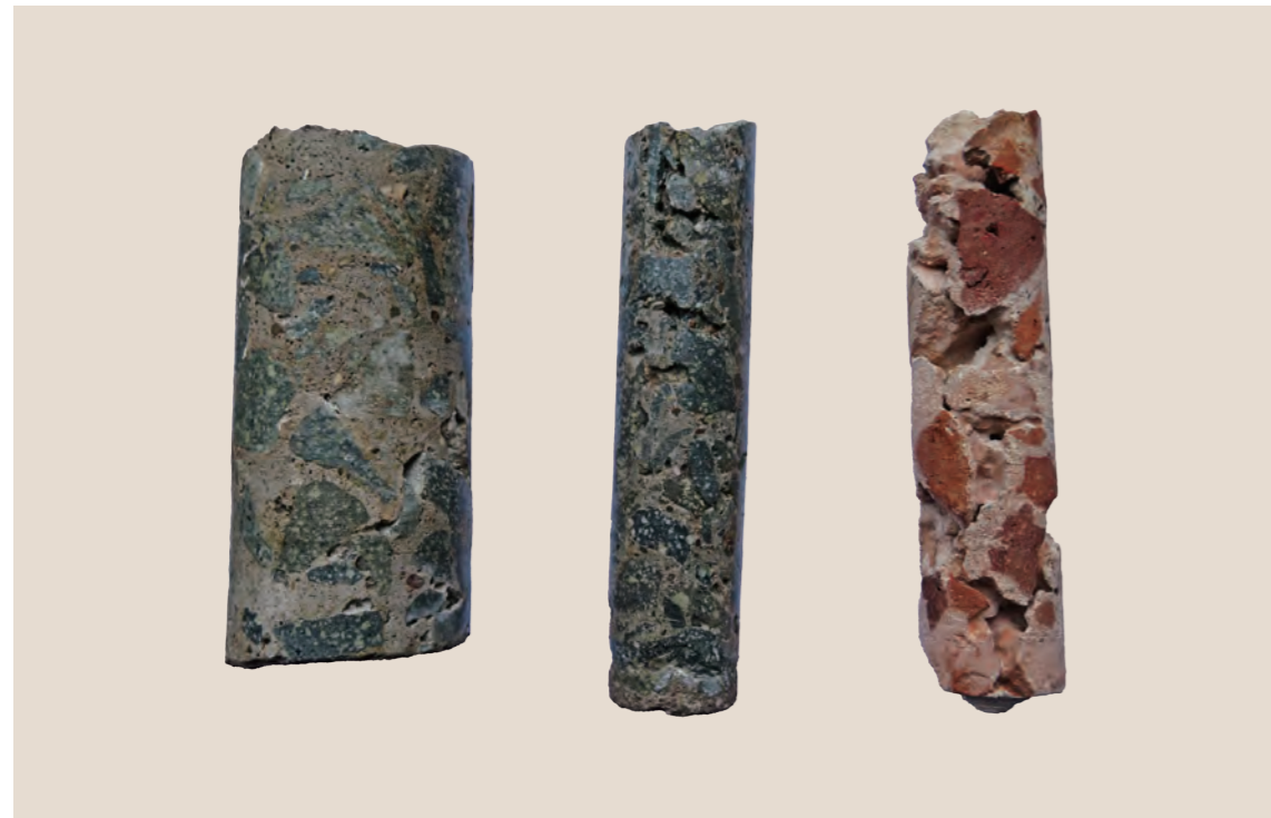
그림 148. 나르덴에서 채취한 다양한 종류의 콘크리트 드릴 코어 샘플. 맨 오른쪽은 1878년에 만들어진 벽돌콘크리트이다. Fig. 148. Drill-cores taken in Naarden of various types of concrete. On the far right, brick-concrete from 1878.
