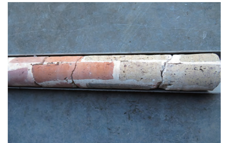
그림 142. 나르덴에서 채취한 드릴 코어 샘플의 세부 모습. 오른쪽에 노란색 벽돌은 날씨에 노출된 성벽의 바깥층이다. 이 벽돌은 성벽의 중심부를 구성하는 주황색 벽돌보다 더 단단하고 밀도가 높다. Fig. 142. Detail of a drill-core taken in Naarden. The yellow stones on the right, form the outer layer of the wall, exposed to the weather. They are of a harder and denser quality than the orange bricks that form the core of the wall.
