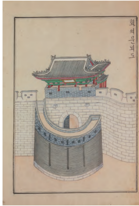
그림 198. 화성의 성문 중 하나를 표현한 그림으로 그림 200의 포루와 같이 다양한 종류의 조적조가 보인다. 여장은 일반적인 줄눈으로 되어있고, 웅성의 아랫부분은 수평 줄눈만 볼 수 있다. 성벽 자체는 자연석으로 만들어졌다. 자연석 여장은 성문 위에 있는 문루의 벽돌 여장으로 끊어져 있다.
