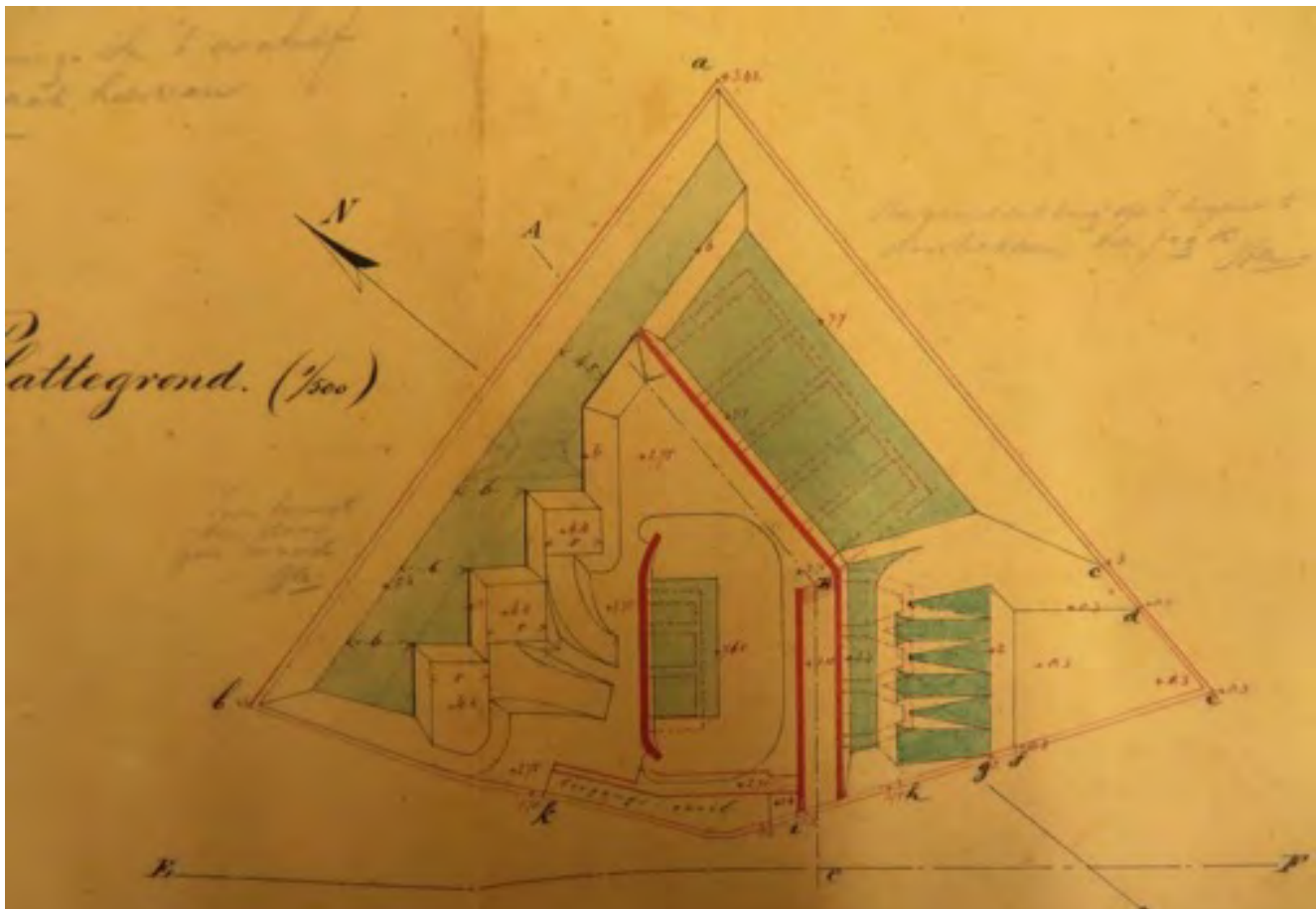
Afb. 18: De plattegrond van ravelijn 5 met het plan van 28 september 1872. In de rechter flank zijn een drietal kazematten voorzien. De linkerszijde van het ravelijn wordt voorzien van geschutopstellingen in de openlucht. Voorin het ravelijn komt een kazerne te liggen. (NA 2.13.01-3583-56G)
