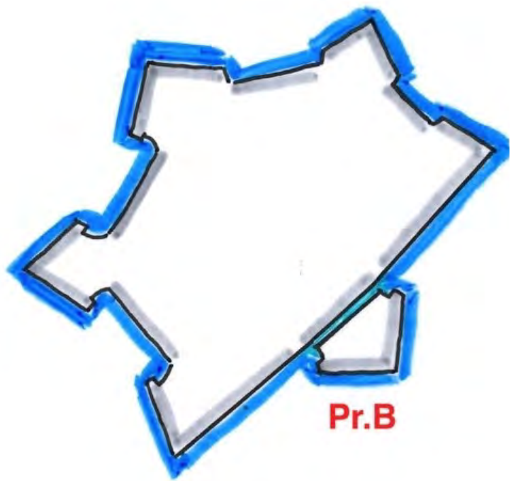
Afb. 15: Schematische weergave van de gevolgen van deze voorgestelde ingreep. b: om het rechte front tussen de bastions Oranje en Turfpoort te maken moeten de bestaande courtines en flanken worden afgebroken en moet er een gracht aangelegd worden tussen bastion Promers en de vesting.
