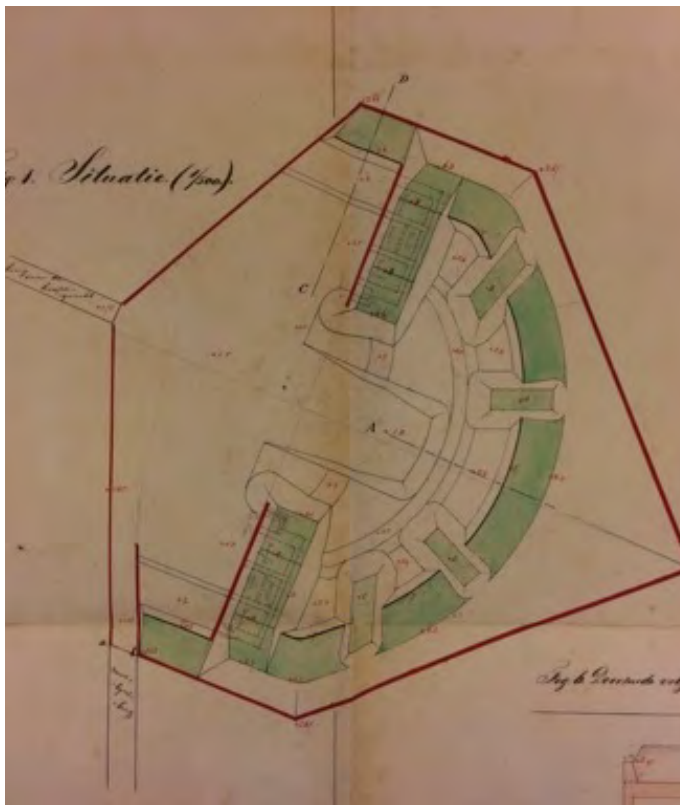
Afb. 29: De plattegrond van ravelijn 6 van 28 april 1873. Er is slechts sprake van twee kleine kazernes annex remisegebouwen en geschutsopstellingen in de openlucht. De kazematten zijn geheel uit het plan verdwenen (NA 2.13.01-3608-71G)
