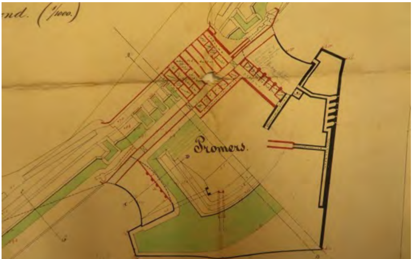
Afb. 13: Detail van het bastion Promers. In de keel van het bastion komt een grote kazerne te liggen. Dwars door de kazerne loopt een gracht die aansluit op de vestinggracht. De kazernes aan weerszijden van deze gracht zijn bereikbaar via rolbruggen. In de flanken van het bastion zijn kazemattengebouwen aangebracht (NA 2.13.01-3583-56G)
