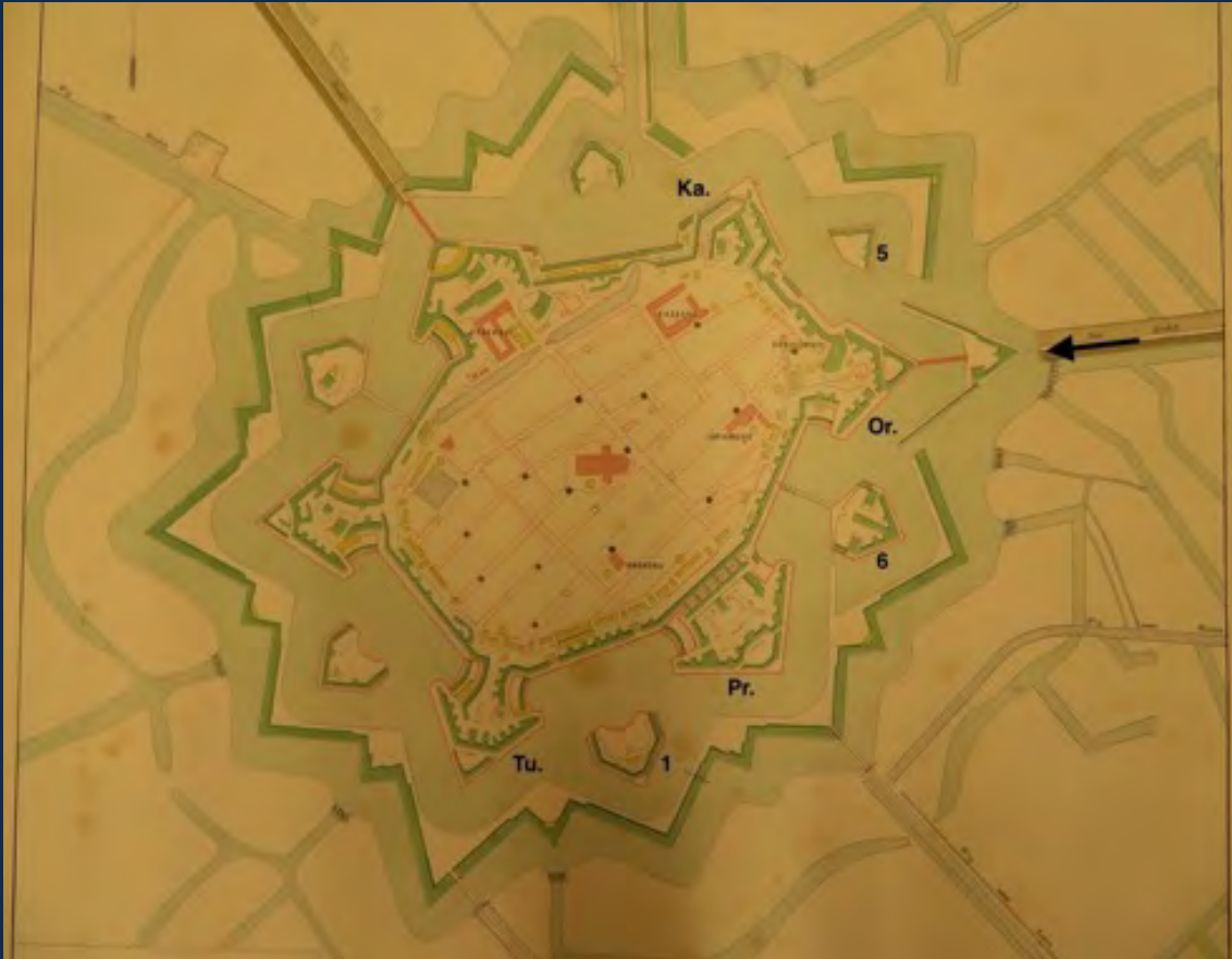
Afb. 1: Plattegrond van de vesting. Met de pijl is de aanvalsroute over de zeedijk aangegeven. De Oostbeer sluit aan de op deze dijk en op de saillant van bastion Oranje. De bastions Katten, Oranje, Promers en Turfpoort zijn aangegeven met Ka., Or., Pr. respectievelijk Tu. De nummers 1, 5 en 6 duiden op de gelijknamige ravelijnen. (basistekening NA-1566 01 OBGK K7-51)
