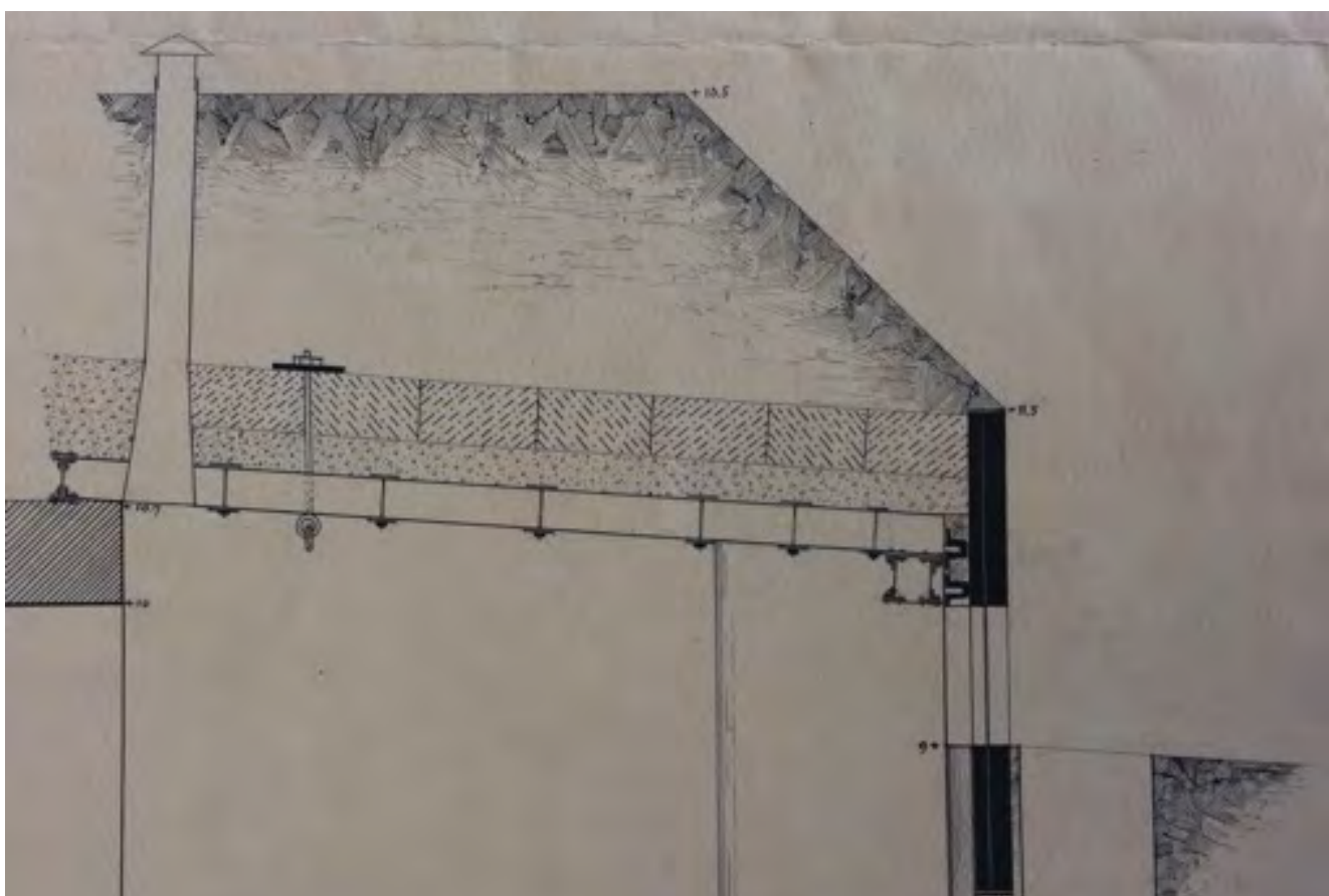
Afb. 27: Detail van de doorsnede van de geschutstanden (NHA 548, inv. nr. 192)
