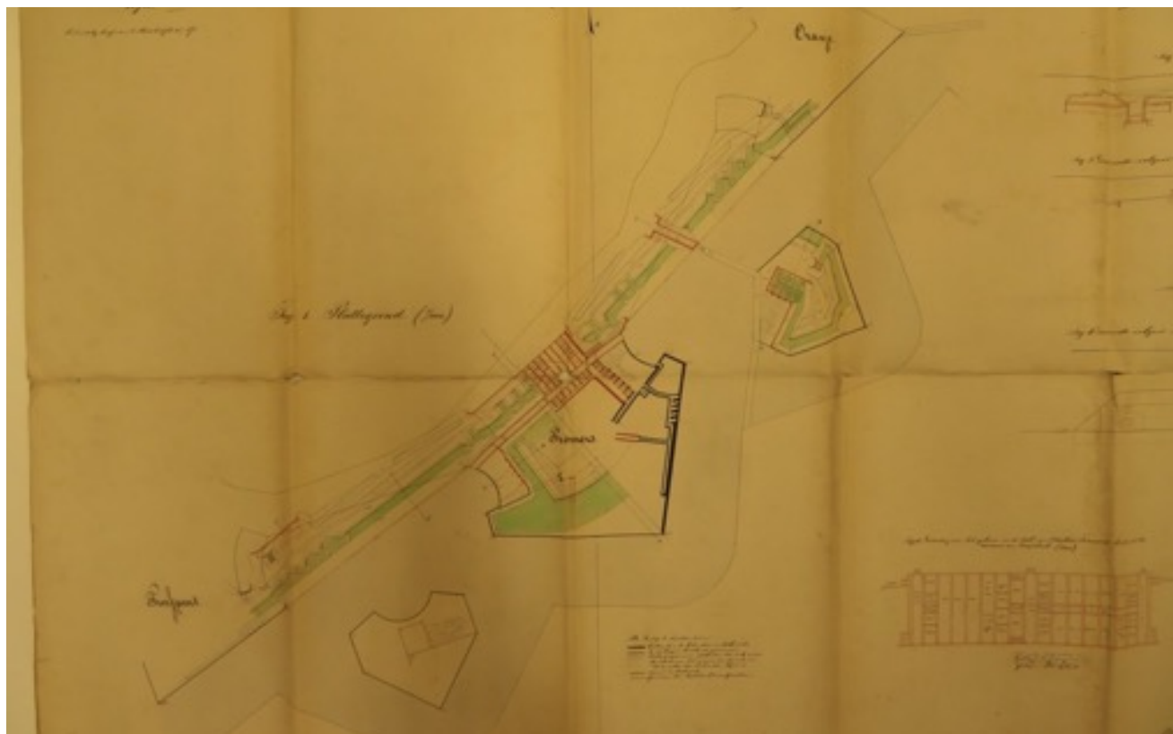
Afb. 12: Het ontwerp voor bastion Promers van 1 maart 1873. Vanaf het bastion worden nieuwe courtines aangelegd die aansluiten op de saillant van de bastions Oranje en Turfpoort. Bastion Promers wordt daarbij middels een gracht losgesneden van de rest van de vesting en komt als een caponnière los voor een recht front te liggen (NA 2.13.01-3583-56G)
