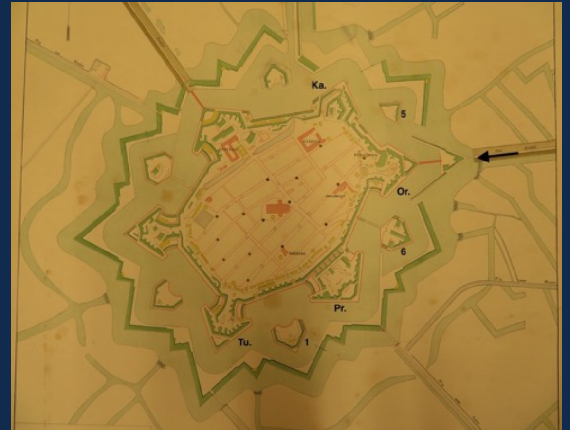
Afb. 1: Plattegrond van de vesting. Met de pijl is de aanvalsroute over de zeedijk aangegeven. De Oostbeer sluit aan de op deze dijk en op de saillant van bastion Oranje. De bastions Katten, Oranje, Promers en Turfpoort zijn aangegeven met Ka., Or., Pr. respectievelijk Tu. De nummers 1, 5 en 6 duiden op de gelijknamige ravelijnen. (basistekening NA-1566 01 OBGK K7-51)
