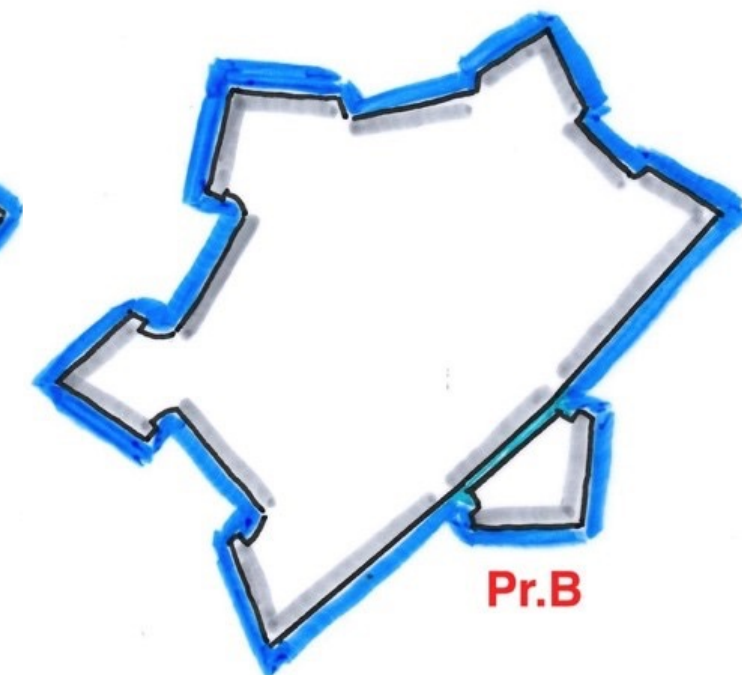
Afb. 15: Schematische weergave van de gevolgen van deze voorgestelde ingreep. b: om het rechte front tussen de bastions Oranje en Turfpoort te maken moeten de bestaande courtines en flanken worden afgebroken en moet er een gracht aangelegd worden tussen bastion Promers en de vesting.
